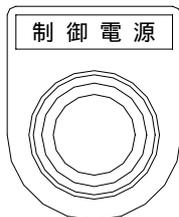
アクチュエーター（電磁弁等の出力機器）に電源を供給するスイッチです。
