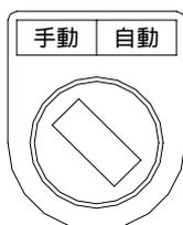
「自動運転」は、バッグ装着（2点チャック）をする事で、前述の自動充填を行います。
