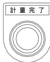
計量完了時に、点灯します。
