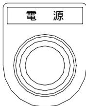
制御盤に電源が供給されていると点灯します。
