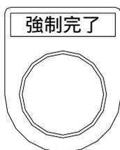
自動的に計量完了状態にならない時に、使用します。
