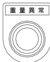
重量異常（ロードセル指示計信号が不足・過量）時に点灯します。
