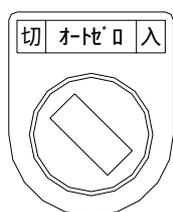
「入」にすると自動投入前に、ロードセル指示計重量値をゼロした後で、自動投入を開始します。
