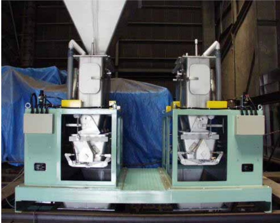
投入ゲート駆動部をエアシリンダーからサーボモーターに変える事によって、投入ゲート開度（口径）を任意の位置で止める事ができます。また開閉のスピードも制御（電氣的に）側にて変える事ができます。従って、今まで難しかった事ができるようになりました。
