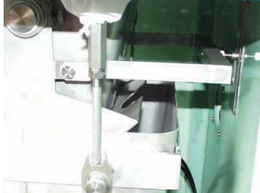
投入ゲートをサーボモーターで制御する事で、任意のスピードで開閉したり任意開度で停止する事ができます。小投入状態は、写真の投入ゲート半円状の切りかぎから計量物が落下する位置で停止し、微量投入します。定量重量値（定量設定値 - 落差設定値）に達しますと、小投入状態 全閉になり、計量完了信号を発します。
