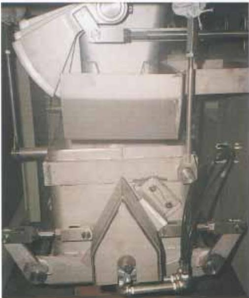
計量開始と同時に、大投入ゲート、中投入ゲート、小投入ゲートがエアシリンダーにより開放します。
